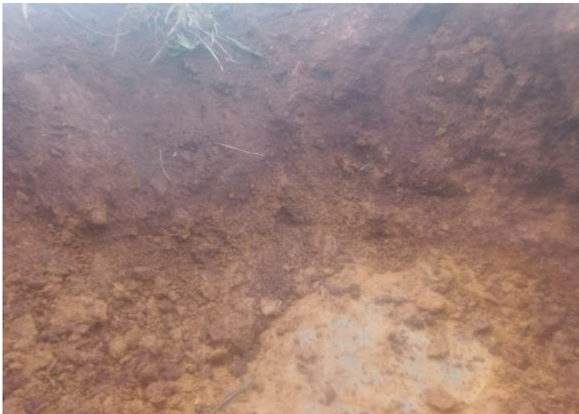
Foto 03: Vala de inspeção para verificação do substrato de paralisação (com pedras) do furo SP6.
